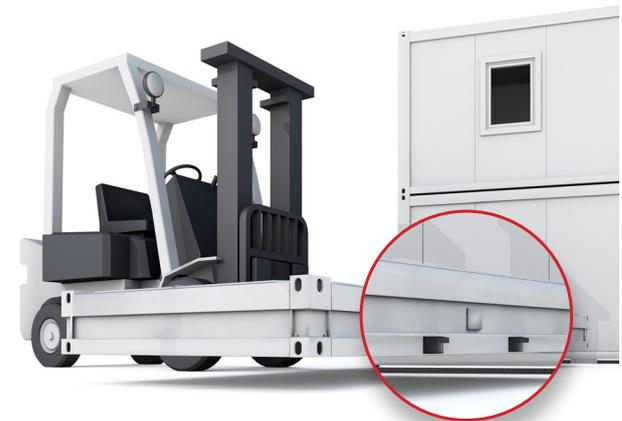
Modulare Einheiten mit Gabelstapler-Öffnungen
