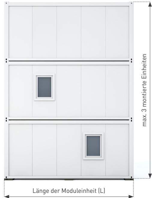
Abb. 1: Stapel einer montierten Moduleinheit
