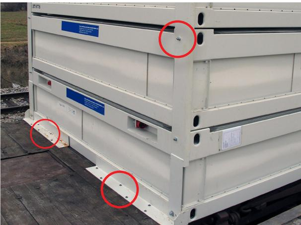
Die Moduleinheiten müssen mit Metallprofilen fixiert werden, um ein Verrutschen der Moduleinheiten zu verhindern.
